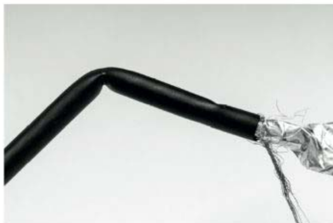
Перелом кабеля на сгибе из-за использования химически вспененного диэлектрика
