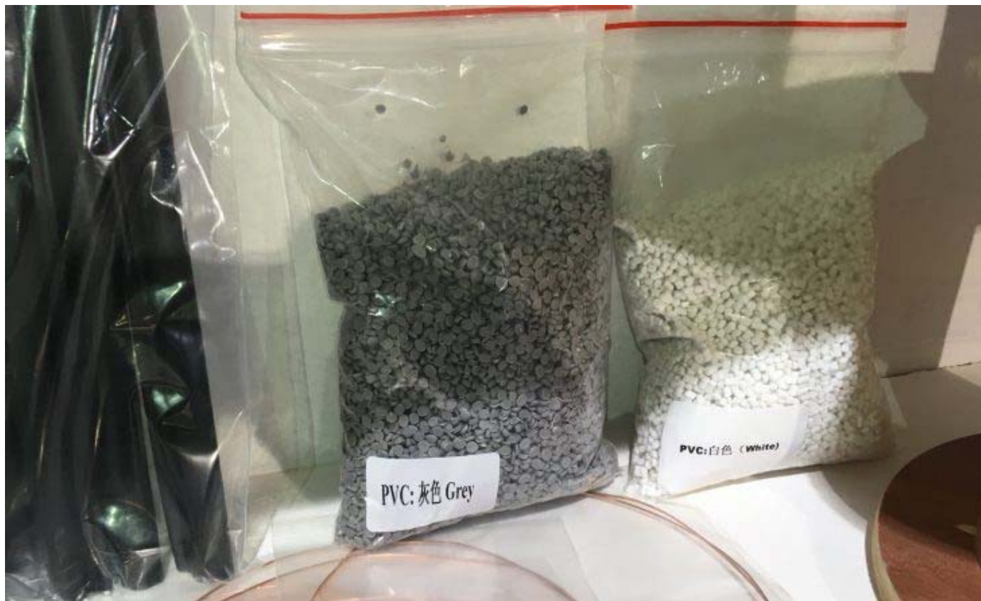
Гранулы цветного PVC для оболочки кабеля производства КНР. Фото с выставки CCBN-2017 (Пекин).
