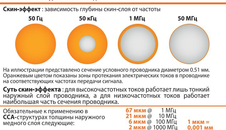
Как мы видим, на частотах порядка 1000 МГц, используемых в современных высокоскоростных сетях доступа, разрешенная толщина медного слоя в проводнике составляет всего лишь **2 мкм**, что исключительно мало. Такой чрезвычайно тонкий медный слой неизбежно разрушается при заделке проводников в разъем. Рассчитывать на то, что производитель из ЮВА будет многократно утолщать слой меди, тем самым резко увеличивая свои затраты, простому потребителю не приходится.
